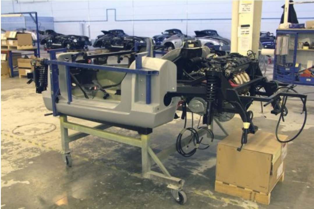
Etape 2 : les éléments de carrosserie en polyester sont collés au châssis. © PGO Automobiles
