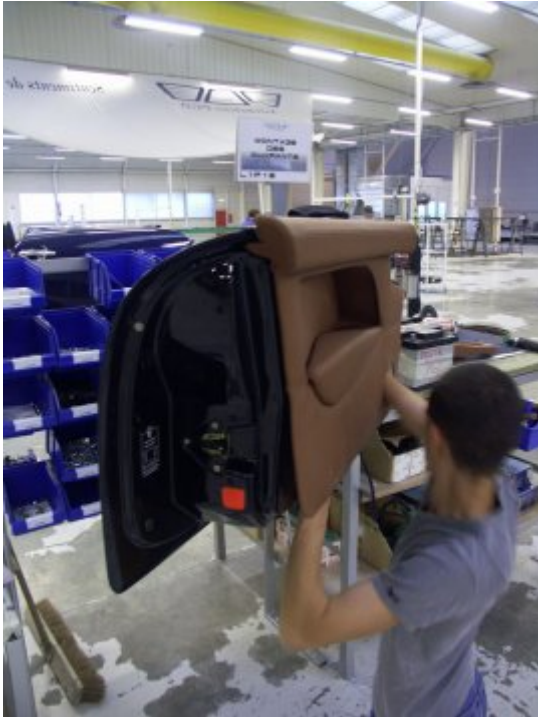
Etape 8 : assemblage des portes sur poste en parallèle de la ligne de production. © PGO Automobiles
