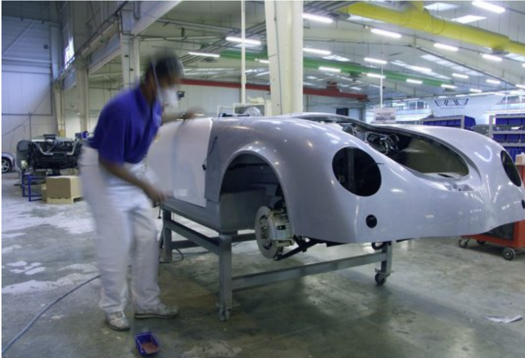
Etape 3 : Collage des éléments de carrosserie et alignement des ouvrants, c'est-à-dire des portes et du capot. © PGO Automobiles
