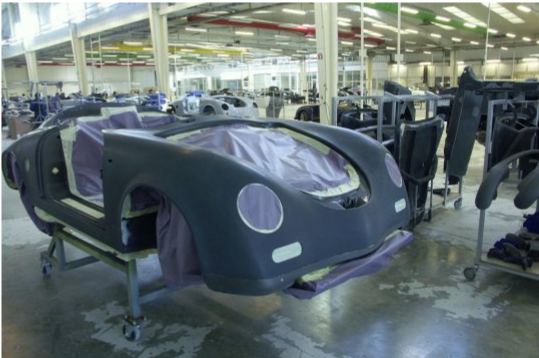
Etape 4 : la voiture est poncée et préparée pour être peinte. © PGO Automobiles
