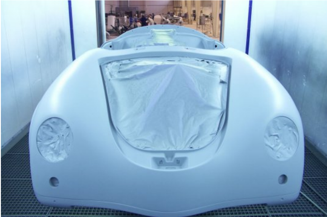
Etape 5 : dans la cabine de peinture, la voiture est apprêtée (une fine couche de peinture blanche recouvre la carrosserie). Il ne reste plus qu'à mettre la peinture. © PGO Automobiles
