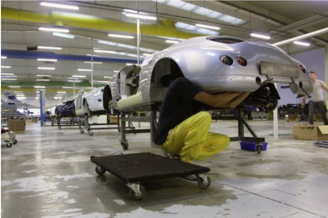
Etape 6 : des accessoires, comme la plaque d'immatriculation, sont ajoutés sur la carrosserie peinte. PGO Automobiles
