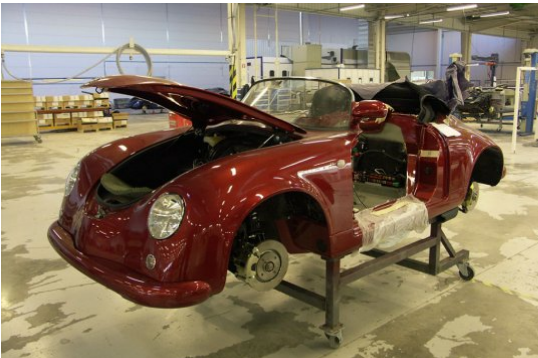
Etape 7 : pose de la sellerie et de la capote. © PGO Automobiles
