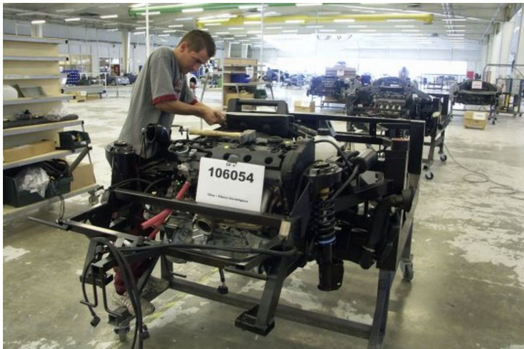
Etape 1 : il s'agit de l'assemblage de la mécanique sur le châssis. © PGO Automobiles
