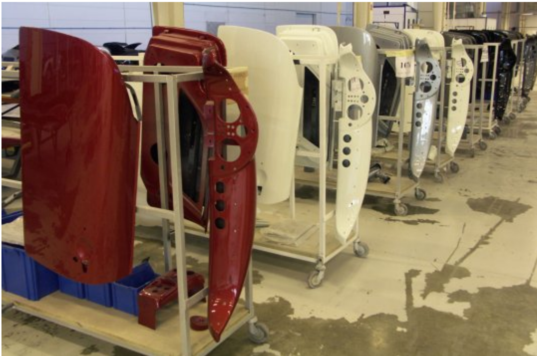
Avant d'être assemblés les différents éléments de carrosserie affectés à chaque voiture attendent sur un support. © PGO Automobiles
