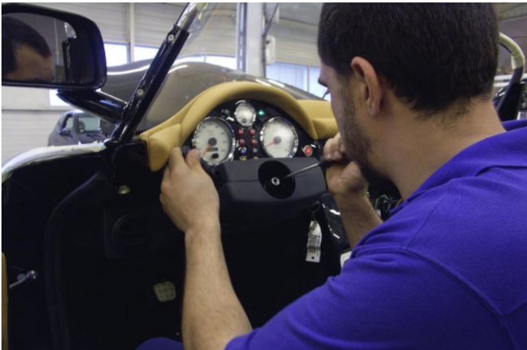
Etape 9 : l'habitacle et la planche de bord sont assemblés. © PGO Automobiles
