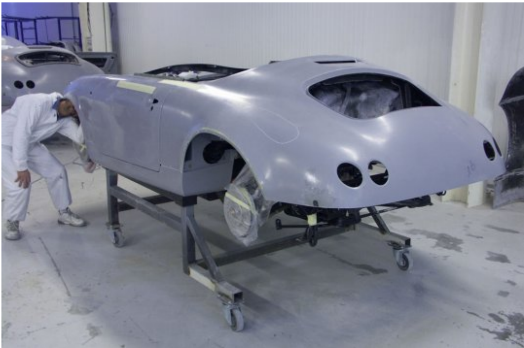
Etape 2 bis : d'autres éléments en polyester sont rajoutés. La voiture commence à prendre forme... © PGO Automobiles
